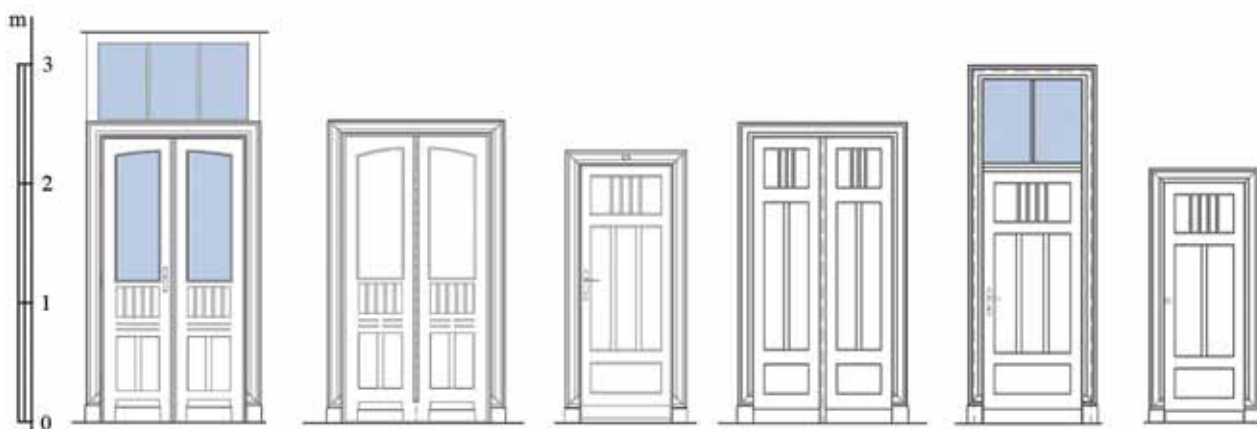
Ilustracja 1-21. Przykłady oryginalnych wzorów stolarki drzwiowej w kamienicy przy Alejach Jerozolimskich 57 z zaznaczeniem przeszkleń, od lewej: główne drzwi wejściowe do lokalu na I piętrze; główne drzwi wejściowe do lokalu na III piętrze; służbowe drzwi wejściowe do lokalu na III piętrze; drzwi pomiędzy pokojami w trakcie przyulicznym; drzwi pomiędzy korytarzem i kuchnią; drzwi pomiędzy korytarzem i łazienką. Źródło: M. Biczuk, P. Prostko, A. Rostkowska [oprac.], Projekt budowlany przebudowy, rozbudowy i nadbudowy budynku mieszkalno-usługowego , Al. Jerozolimskie 57 w Warszawie, Warszawa 2018, mps. w zbiorach Archiwum pracowni architektoniczno-konserwatorskiej Proart
